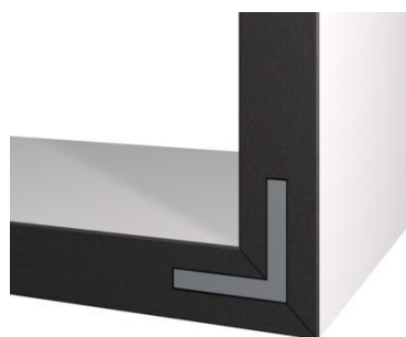
Połączenie narożnikiem Rysunek 19
