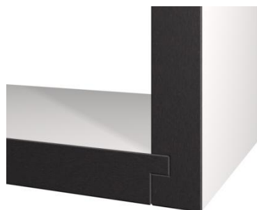
Połączenie rowek-listewka Rysunek 17
