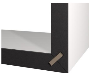
Połączenie na pióro i wpust Rysunek 18
